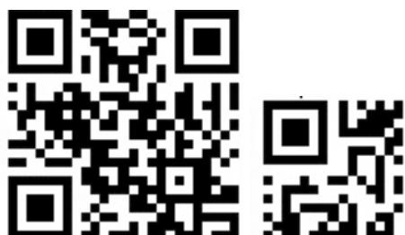
El QR Code aventaja a DataMatrix en rapidez en su lectura y en la cantidad de datos que pueden almacenar. Permite además al usuario elegir entre el nivel de corrección de errores que prefiere, frente al nivel fijo de corrección de DataMatrix.
